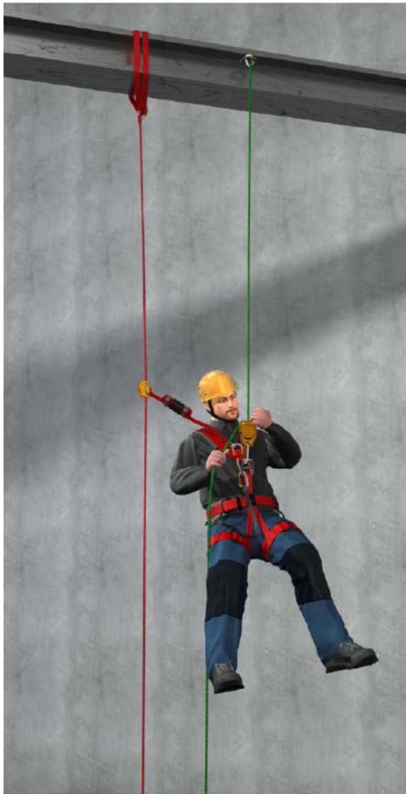
Abb. 1 Systemredundanz : unabhängig voneinander angeschlagenes Tragseil (hier grün) und Sicherungsseil (hier rot).
